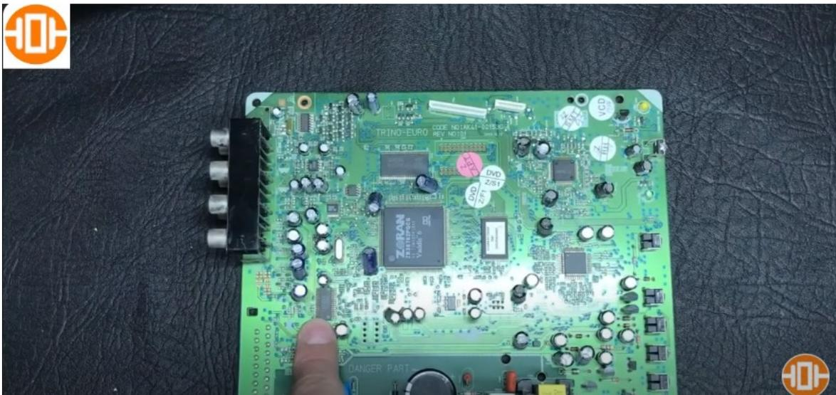
ya que cada circuito integrado requiere un voltaje de corriente continua, entonces nosotros podríamos buscar el data chip o el pin out de uno de estos circuitos integrados
