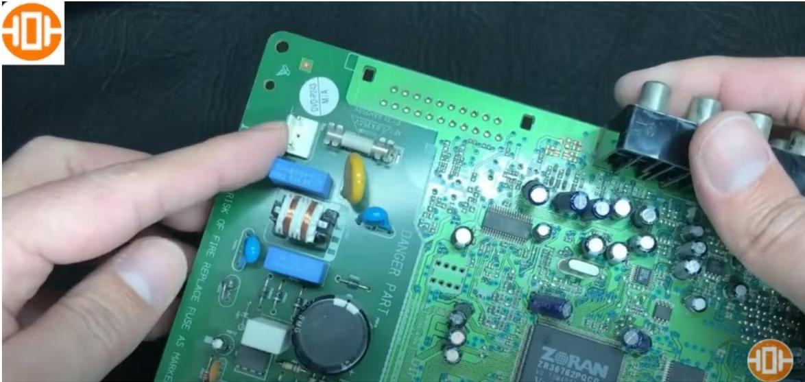
aquí tenemos el fusible, aquí está la parte del filtrado, aquí están los diodos rectificadores y aquí viene la etapa de la fuente conmutada donde él va a generar los voltajes de salida
