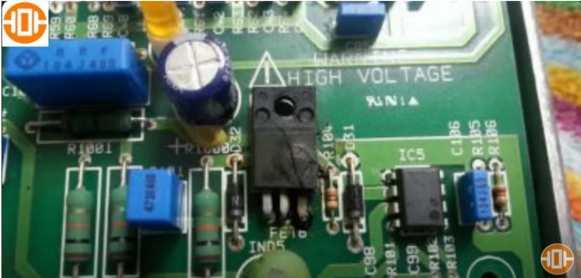
para detectar eso se logra con una simple inspección visual de la tarjeta de la placa electrónica, pero a pesar de encontrar algún elemento dañado, eso no quiere decir que cambiar ese elemento va a resolver el problema, por ejemplo, si ustedes en una placa como esta, por ejemplo, detectaran que el fusible está dañado y ustedes lo cambian posiblemente cuando ustedes vuelvan a conectar la placa se va a volver a dañar el fusible
