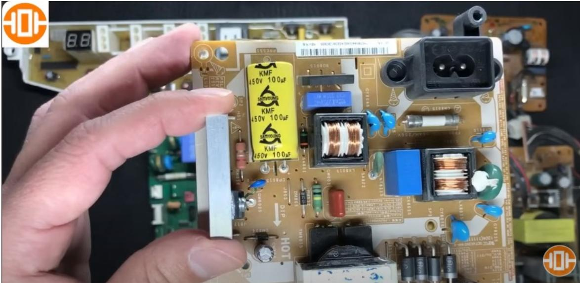
Entonces, en algunos casos esos capacitores pueden quedar cargados fíjense este capacitor el valor de voltaje que tiene es de 450 v
