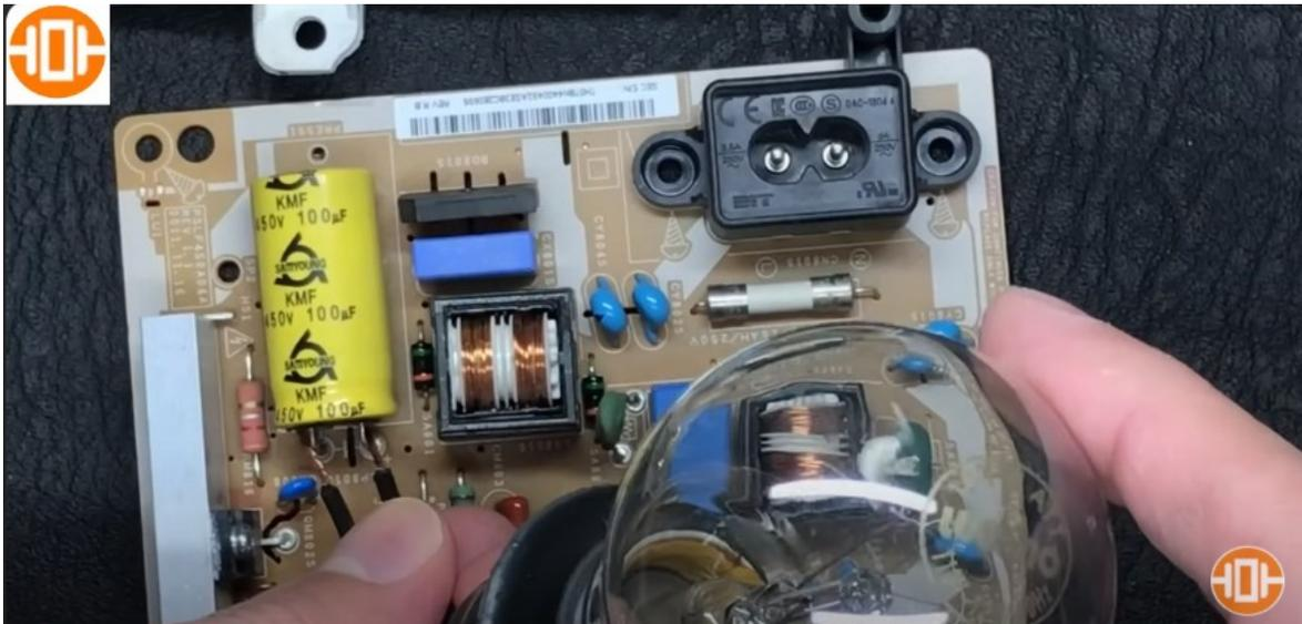
y de esa forma nosotros podemos descargar todos los capacitores de todas las tarjetas electrónicas. Pueden notar que en casi todas las tarjetas electrónicas tenemos capacitores con voltajes altos, fíjense que el capacitor mientras sea más grande quiere decir que trabaja con voltajes más altos o microfaradio alto
