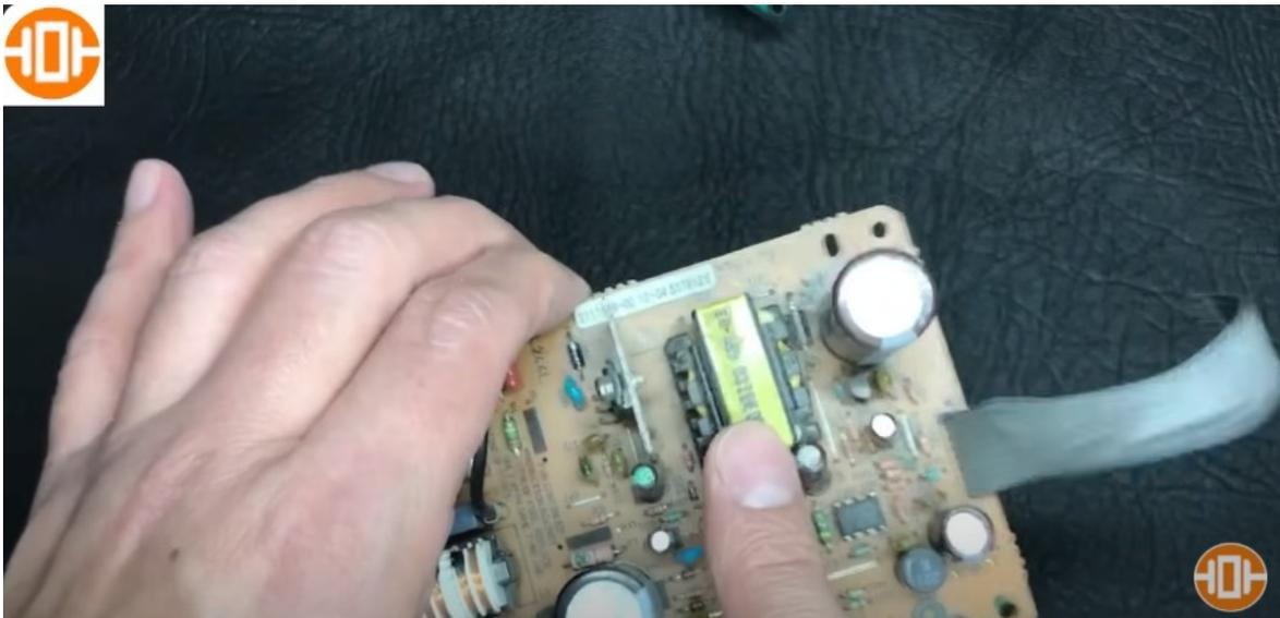
es un transformador de la fuente conmutada y es el elemento principal de la fuente hacia la derecha, en este caso, tenemos la parte de la salida de alimentación de electrónica, básicamente la fuente lo que nos va a hacer es convertir un voltaje que viene por acá de corriente continua pero un voltaje bastante alto
