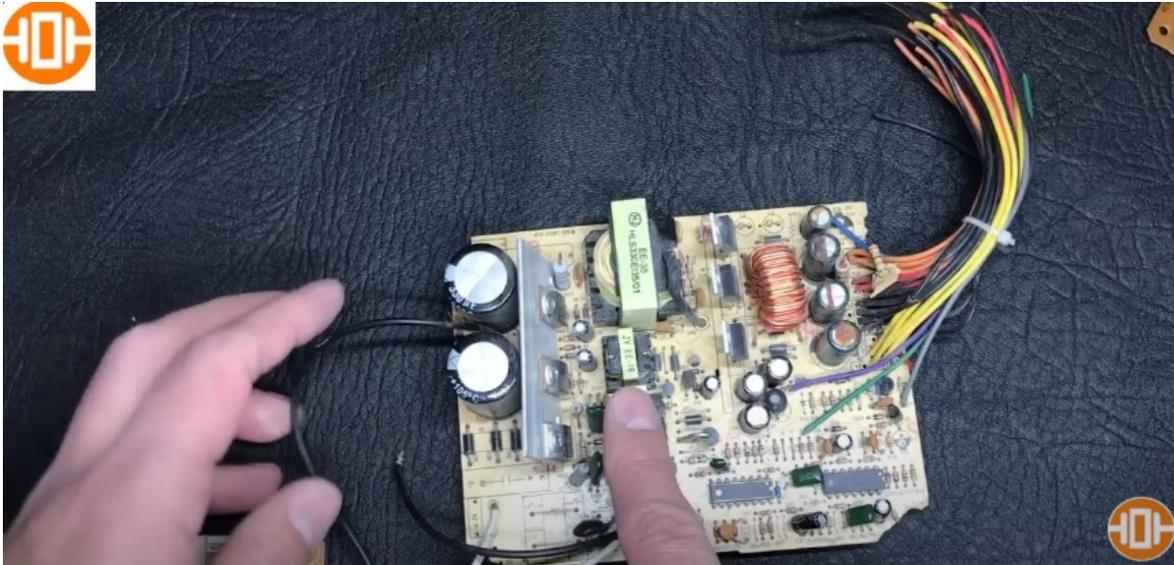
aquí se ve claramente la parte hacia la derecha es la parte de salida de la fuente conmutada, aquí están los diodos rectificadores
