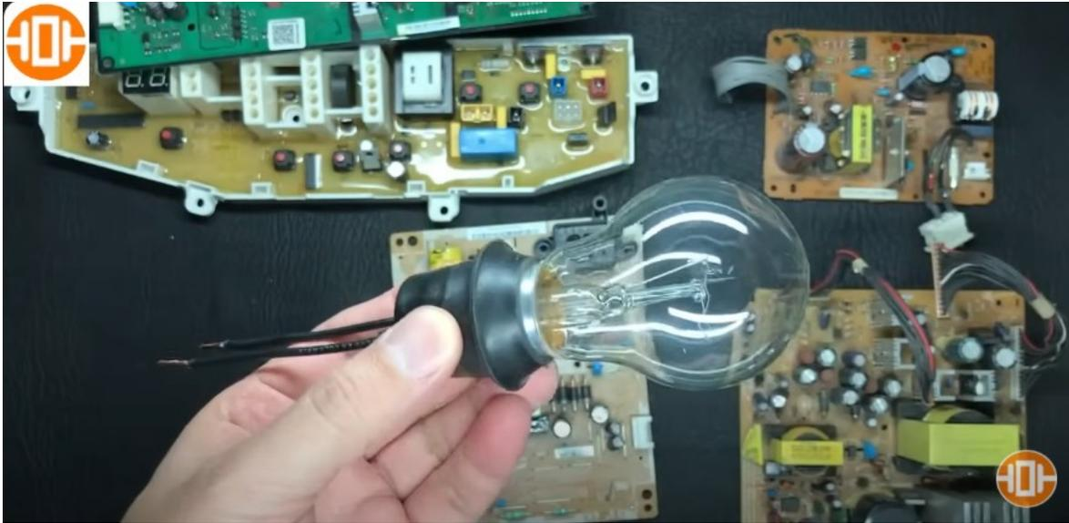
y entonces lo que se hace es muy simple: se coloca el foco en los extremos del capacitor y luego simplemente se hace una conexión y simplemente se tocan sus dos extremos y el foco generalmente podría destellar si estuviese cargado el capacitor
