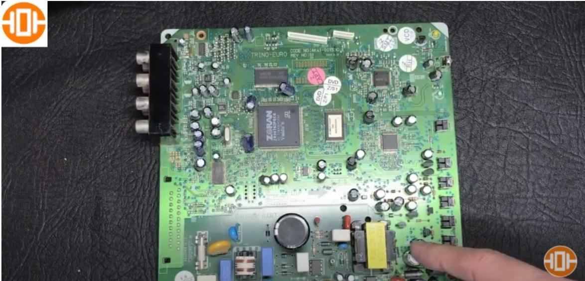
porque esta parte es importante, porque básicamente si los voltajes no están presentes acá no tenemos que seguir revisando más nada hacia adelante. Deberíamos revisar hacia atrás, ya que debemos garantizar en cada tarjeta que los voltajes de corriente continua que van a alimentar a la electrónica estén presentes, entonces, en este caso también nosotros podemos medir algunos voltajes buscando a través de los circuitos integrados
