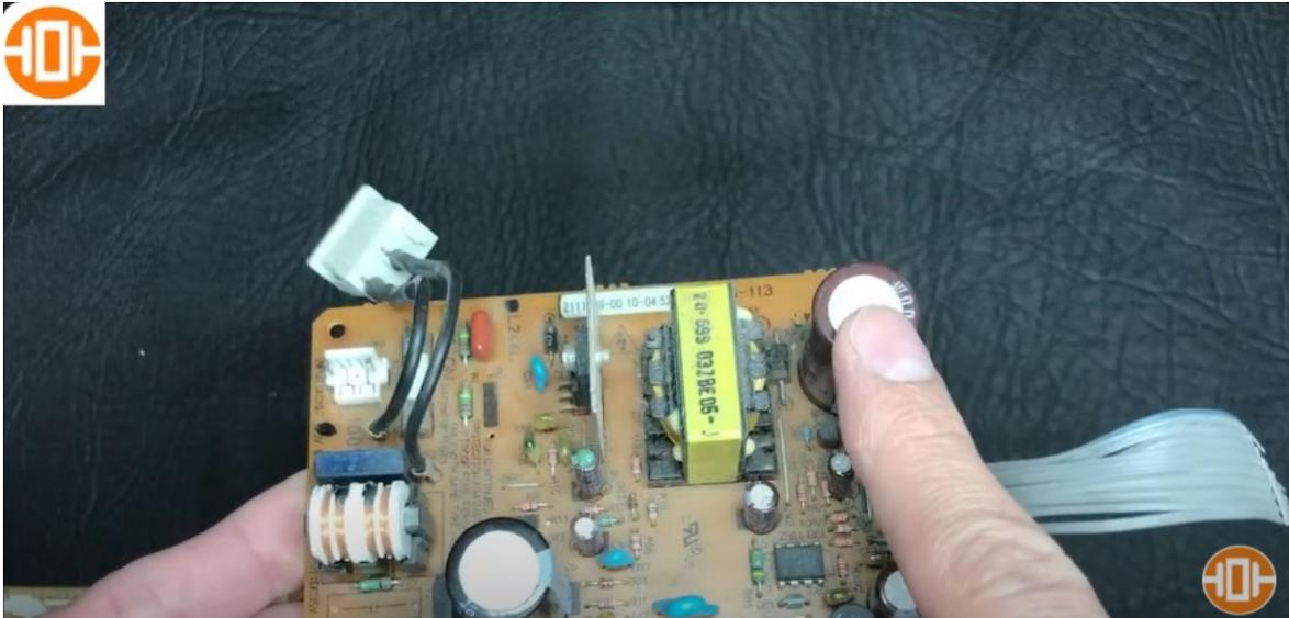
sí son varios voltajes entonces puede requerir varios capacitores, entonces, nosotros deberíamos medir la entrada de este capacitor que seguramente es el voltaje que va a entrar a la fuente
